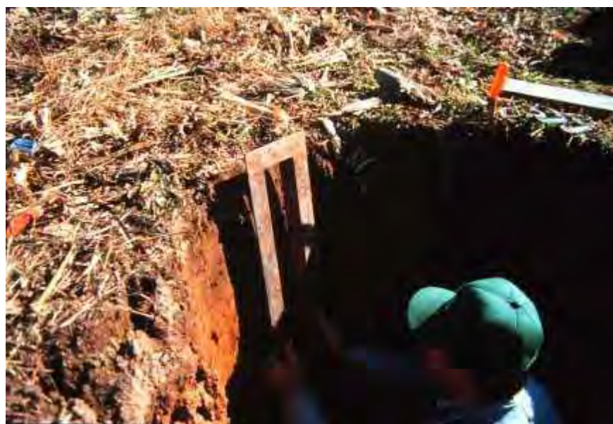
۳. لبه یا تیغه برش را در مقابل نما یا رخ مقطع در داخل قرار دهید تا لبه ها یا کناره های چوکات را علامت گذاری نماید (چکش یا فشار دیگر)
