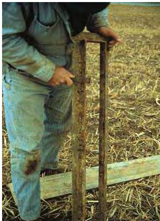
۲. چوکات آهنی دو فته را (با ابعاد داخلی 4" x 2" x 40" در مقابل مقطع اشکار (روباز) قرار دهید.
