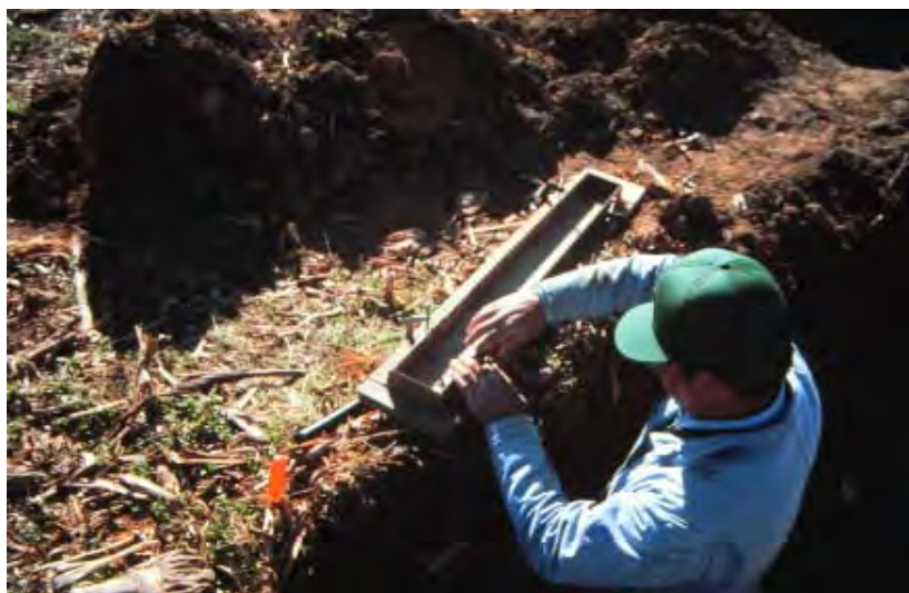
۶. تخته هموار (تقریباً 48" x 8" x 3/4") را روی رخ هموار چوکات آهنی با استفاده از گیره های C شکل، بچسبانید.
